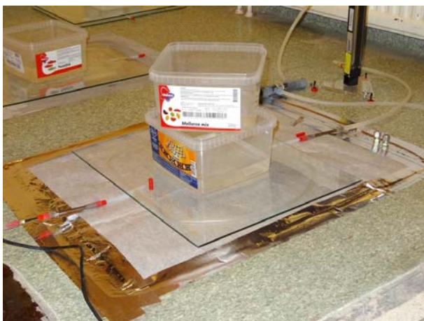
Bild: Lagt spärnskikt och mätcell av glasskiva. Luftprovtagning pågår där renad luft blåses in (tv i bild) luft suges ut på tenaxadsorbent (th i bild). (Plastburkarna med vatten utgör endast en tyngd.)
